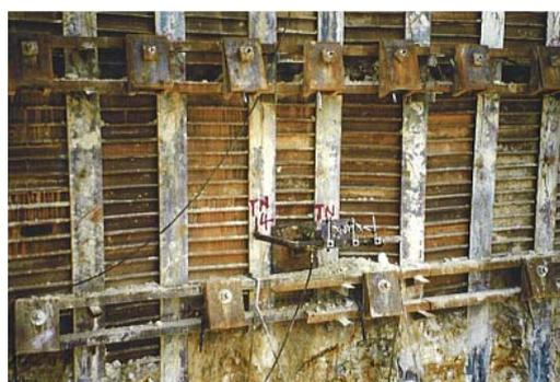
图 33-32 锚杆抗拔试验
