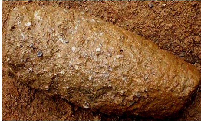
图 24-5 注浆加固体的岩芯图
