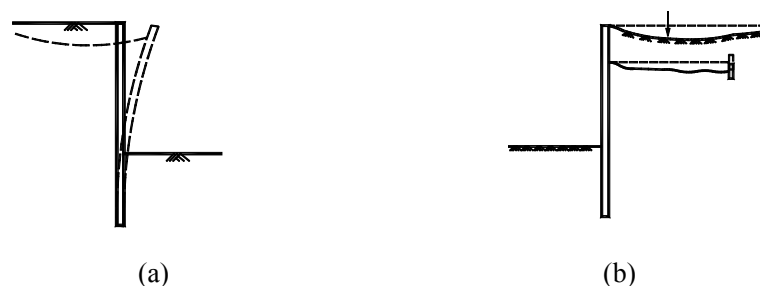
图5.7 墙后土体变形过大引起的破坏
